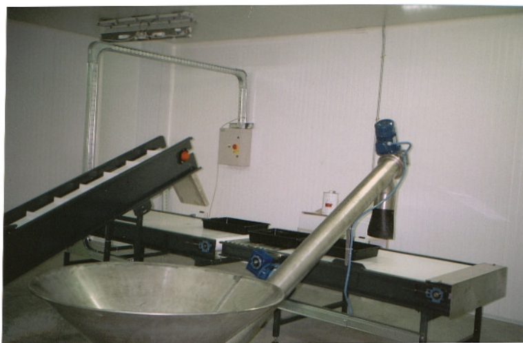
Cella con impianto di semina delle patate (preventivamente trattate) nei vassoi posti sul piano scorrevole
